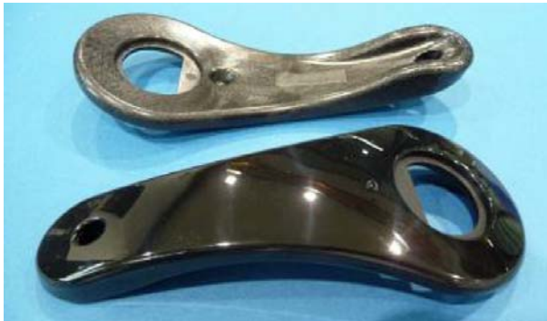
Iza: staro rešenje otvarača sa znacima uvijanja i lošim kvalitetom površine; Ispred: nova tehnologija sa kvalitetnom i sjajnom površinom otpreska
