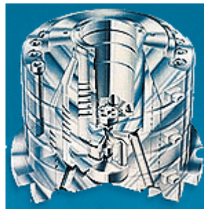
Glava za ekstrudiranje tubularnog PE-LD filma
