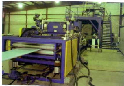
Prvi deo linije za proizvodnju PS-E ploča: odmeravanje, ekstrudiranje, kalibracija i prvi sistem za izvlačenje
