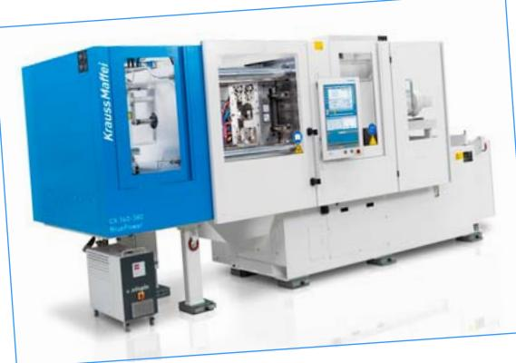
**Serija "CX" mašina sa silom zatvaranja od 350 do 1.600 kN**
