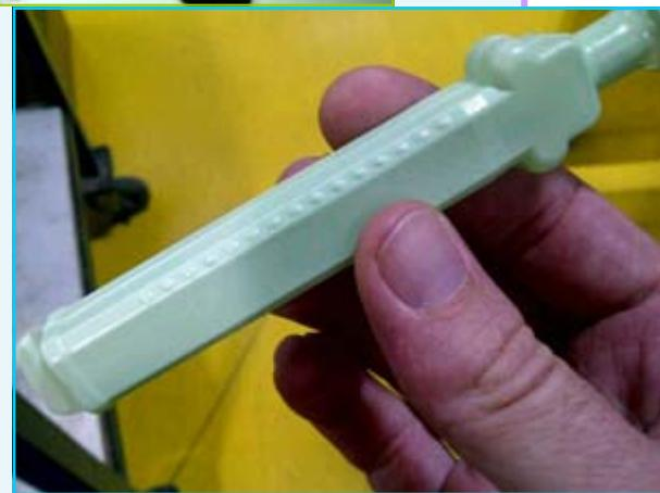
Za izradu 100 jedinica prototipa kalupa za duvano šuplje telo korišćen je postupak 3D štampanja
