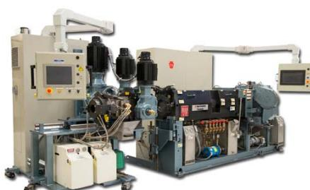
zupčastom pumpom sa sitom za filtriranje "Uth Rollex 70" uz napajanje dvovaljkom. Na raspolaganju je i kontrolna jedinica. Ekstruder je namenjen izradi creva i automobilskih i građevinskih profila. Kom-paktne je osnove i postoji integrisana kontrola temperature. Ekran osjetljiv na dodir olak-
