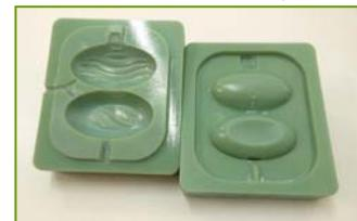
korišćen “Object500 Connex” firme *Stratasys*. Kalupi su namenjeni proizvodnji ambalaže za domaćinstvo i pranje ruku, uključujući zatvarače za boce i držače za osveživače u toaletu.
