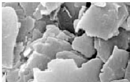
Najčešći komercijalni tipovi su mleveni sa srednjom veličinom čestica 1-15 µm. Pločice imaju sendvič strukturu u kojoj dva sloja silicijum-dioksida sadrže centralni sloj od magnezijum-oksida ili hidroksida.
