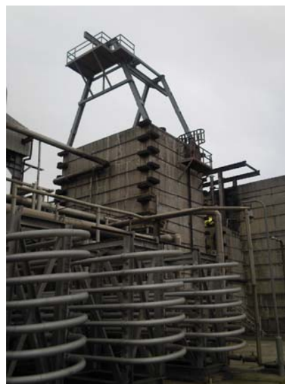
Hladnjak etilena i reaktorski zid
