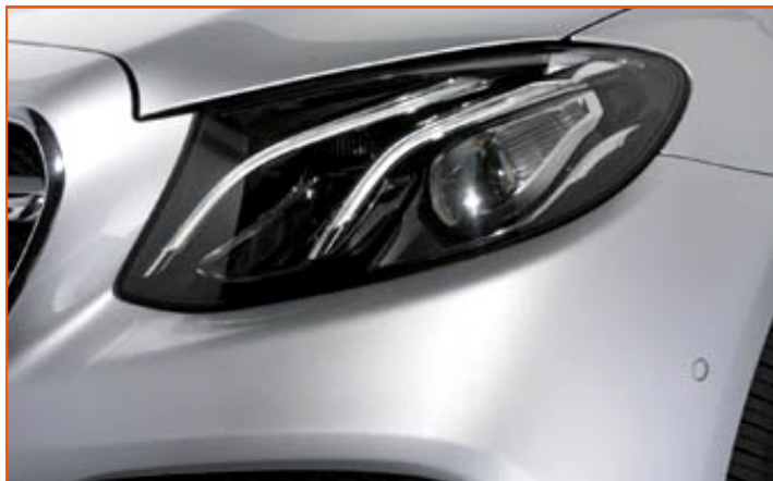
Poklopac fara na modelu "mercedes E" izrađen je od transparentnog polikarbonata iz obnovljivih izvora
