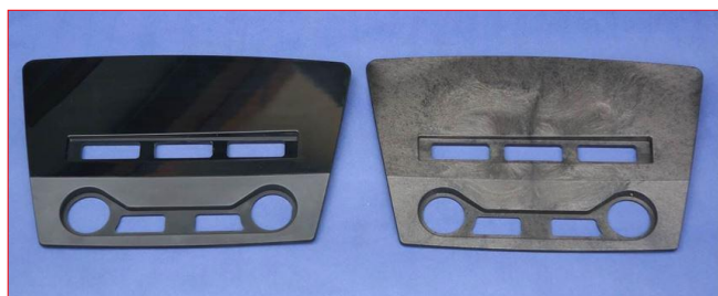
Dekoratívni panel izrađen od blende PC+ABS. Uz odgovarajuće hlađenje postiže se dobar kvalitet površine otpreska (levo) i obrnuto (desno)
