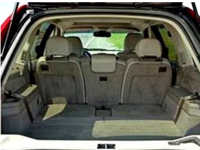
Oblikovane i prevučene saćaste ploče kao podloga u prtljažniku putničkih automobila (izvor: EconCore)
