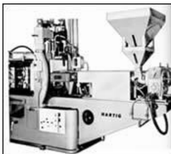
Firma Waldron-Hartig zamenila je klipnu mašinu rešenjem s novim pužnim vijkom 1962. godine
