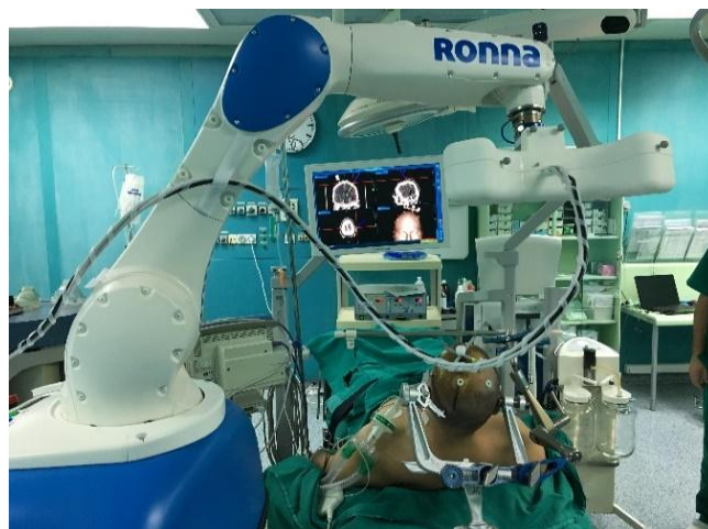
Slika 2. Priprema za operaciju. Preciznost određivanja mjesta bušenja \pm 0,1 mm (uobičajena kirurška \pm 1 mm) (Foto: B. Jerbić)
